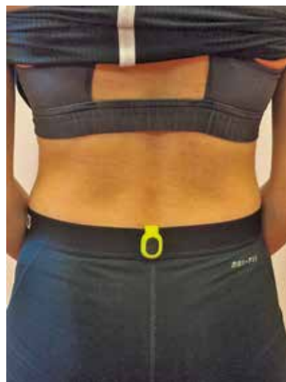
Slika 1. Namestitev senzora Garmin Running Dynamics Pod na spodnji ledveni del trupa
